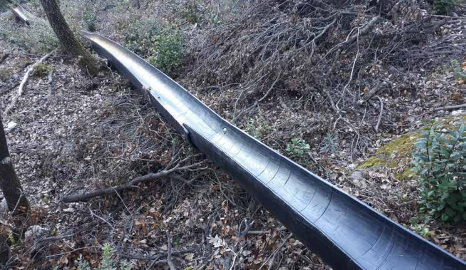
Figura 1. Desembosque por canales en Mura (Bages) con tubos de fabricación propia. Febrero 2019.
