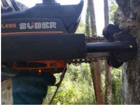
Fotografía 2. Prueba del prototipo de la máquina Coveless 3C18, en la parte de la derecha se puede ver el patinete protector para controlar la profundidad de corte con el sensor incorporado. Foto de CFC
