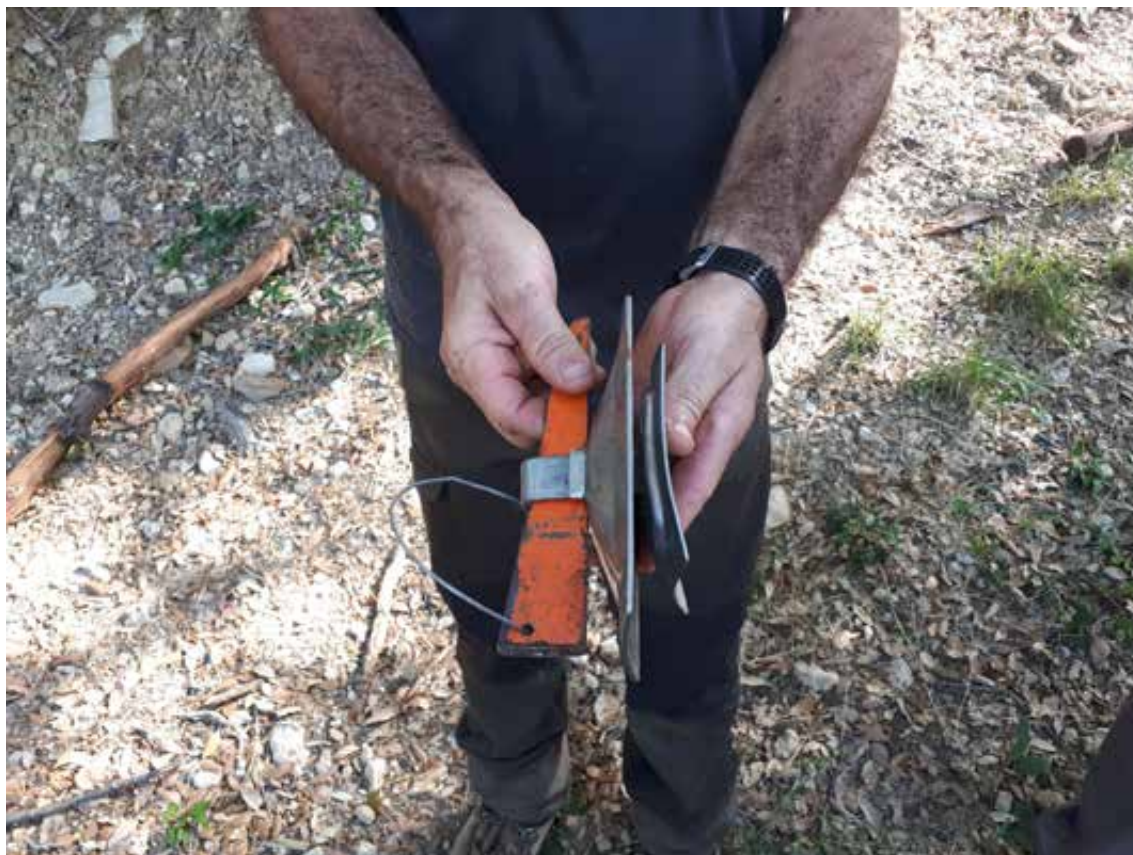
Figura 2. Detalle del enganche empleado por el ONF para la unión de los canales.
