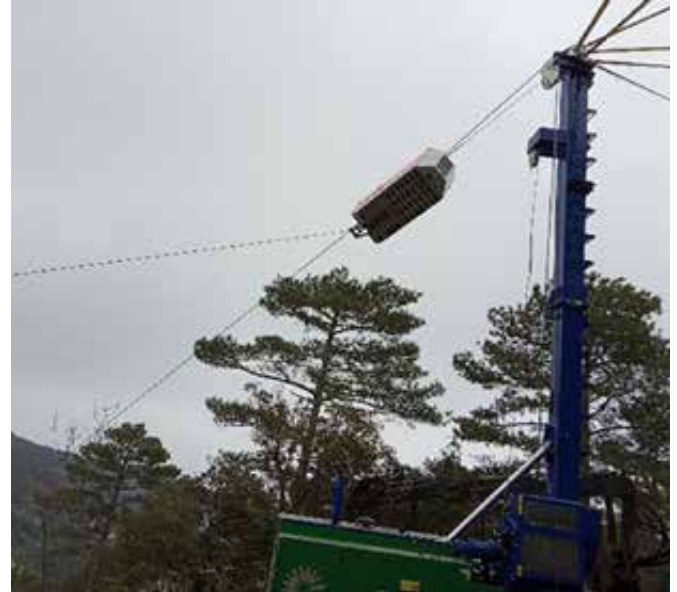
Fotografías 4 y 5. Operario enganchando los árboles con el sistema de chokers (izquierda) y posición del carro durante el viaje lateral (derecha).
