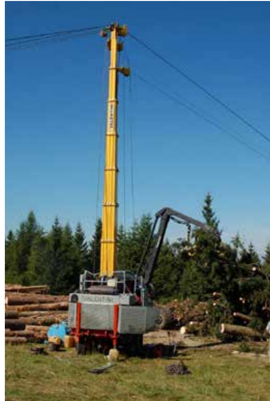
Fotografía 7. Procesadora forestal (en segundo plano) desramando y troceando árboles enteros sacados con cable aéreo.
