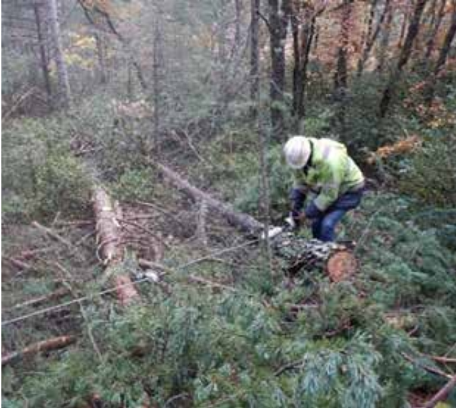
Fotografías 4 y 5. Operario enganchando los árboles con el sistema de chokers (izquierda) y posición del carro durante el viaje lateral (derecha).
