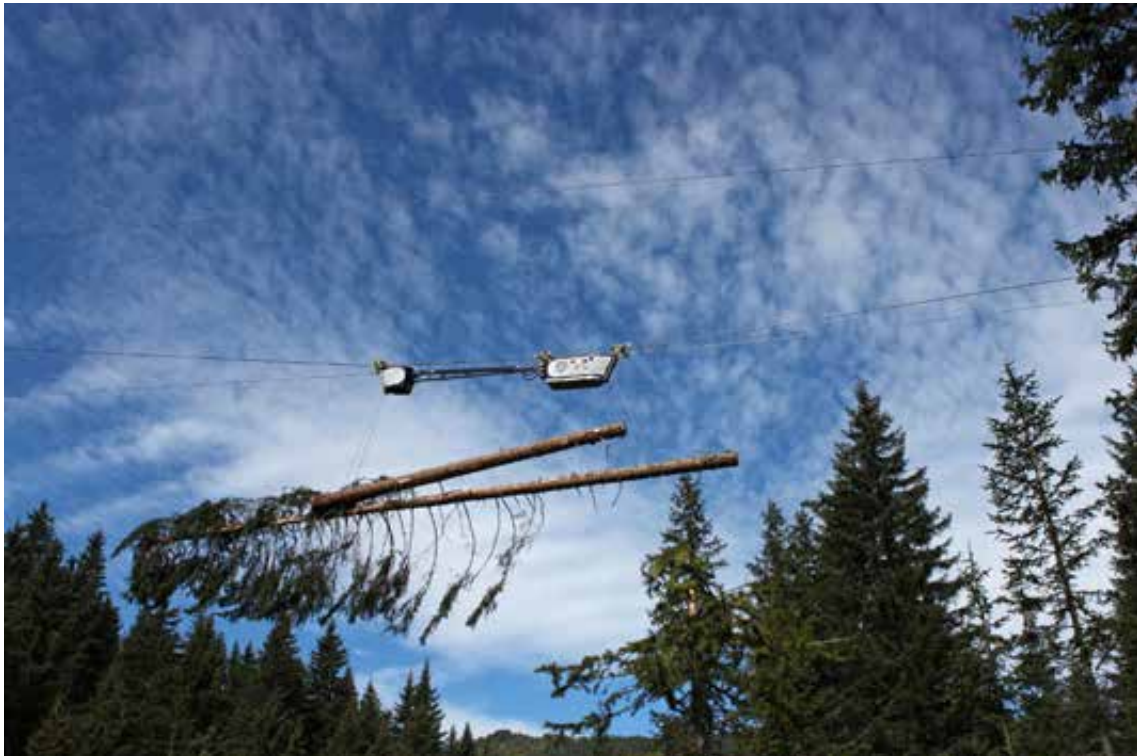
Fotografía 6. Carro de doble enganche sacando un árbol entero en dos trozas, en un aprovechamiento en los Alpes italianos.
