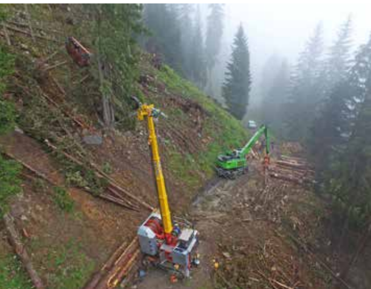
Fotografía 1. Sistema de cable aéreo tricable con el modelo V850 de la marca Valentini Teleferiche.
