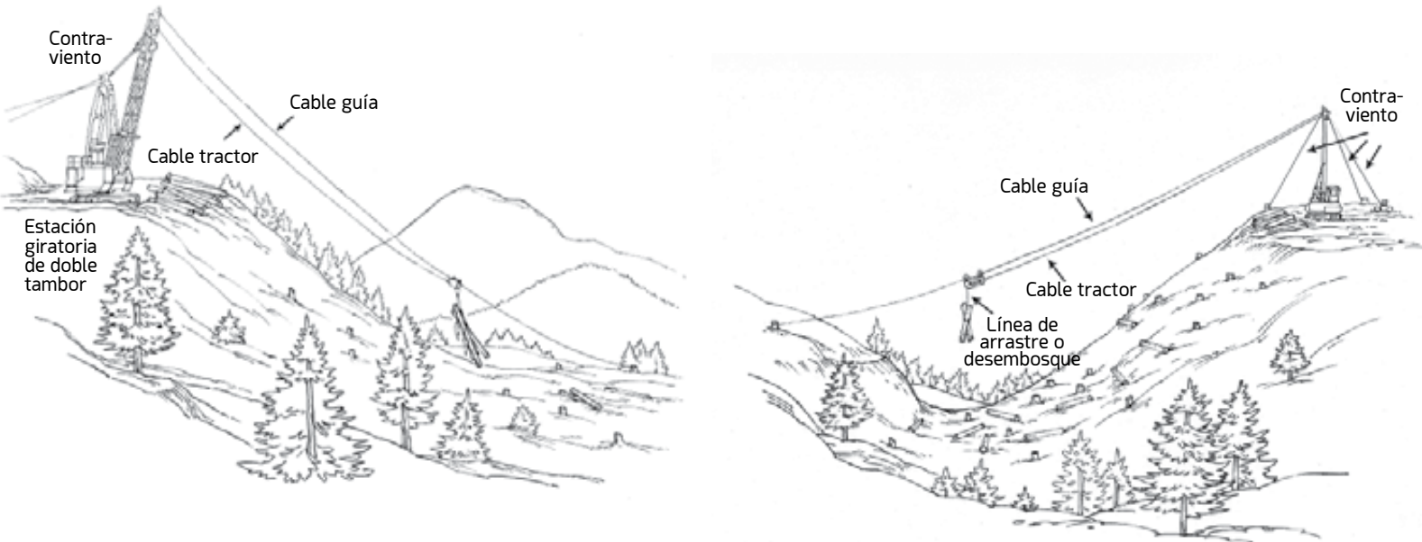
Figura 1. Sistema de desembosque con cable aéreo con madera semisuspendida (izquierda) y suspendida (derecha). Fuente: Visser y NZ School of Forestry, 2016
