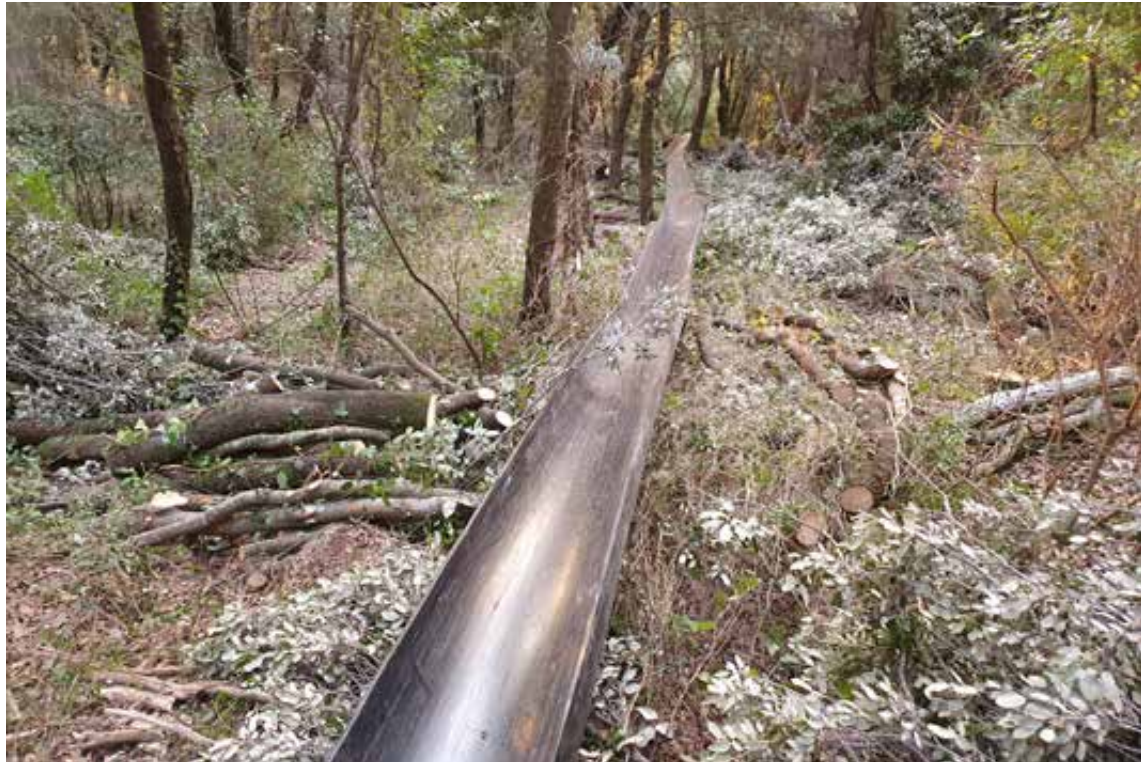
Figura 5. Canal instalado para el desembosque.
