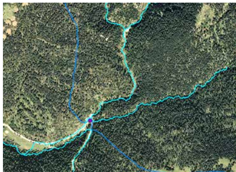
Figura 4. Se observa en color azul oscuro el límite de la cuenca y en color azul claro el recorrido de los cursos de agua calculados a partir de MDE de la zona. Se observa que el curso de agua circula un tramo por el camino. Este tramo es el que ha sufrido las fuertes erosiones de la caja de manera recurrente. Figura de Montserrat Solanelles sobre ortofoto del ICGC
